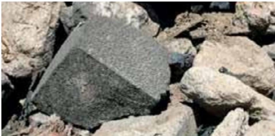
Los materiales pétreos recuperados de residuos de construcción, como la mezcla se obtienen a partir de la recuperación y procesamiento de residuos generados en la construcción y demolición de edificios y estructuras.
