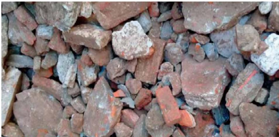
Los materiales pétreos obtenidos a partir de la recuperación y procesamiento de residuos de la construcción y demolición de edificios y estructuras. Los procesos a los que se someten son: trituración, cribado y clasificación obteniendo como producto final, áridos reciclados para nuevos proyectos. Este producto se conoce popularmente como cascote y tiene una granulometría mayor a 63,5 mm.
